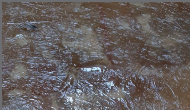
Stratificazione ancora fresca con resina poliesteri e Mat.
