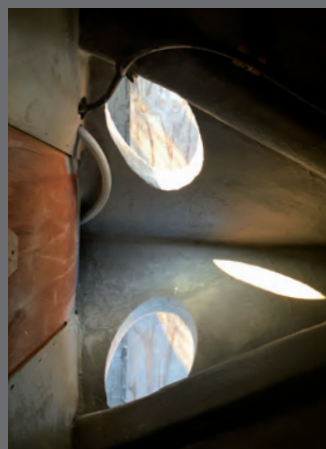
Spessori di vetroresina realizzata con stratificazione manuale in barche di fine anni '70.
