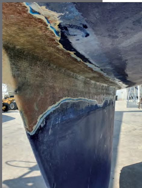
Stratificazione della vetroresina.
