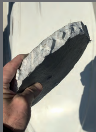
Spessori di vetroresina realizzata con stratificazione manuale in barche di fine anni '70.
