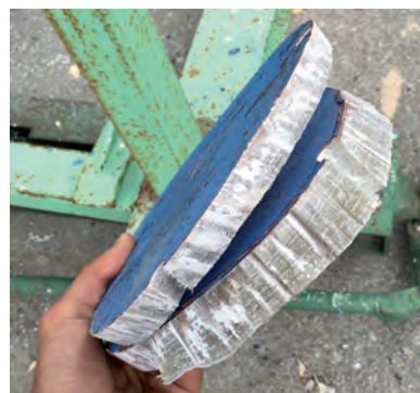
Vetroresina laminata a mano a base poliestere e E-Glass.
