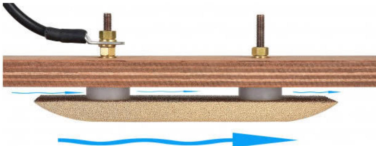
Quando facciamo entrare all'interno della barca un voltaggio pericoloso di 220 volt, le carcasse metalliche di carica batterie, inverter, boiler e le prese elettriche sono potenziali responsabili di dispersioni o corti circuiti. Per questo motivo dovrebbero essere collegati a un sistema comune di massa dell'imbarcazione, oppure essere costruiti conformemente al principio del doppio isolamento.
