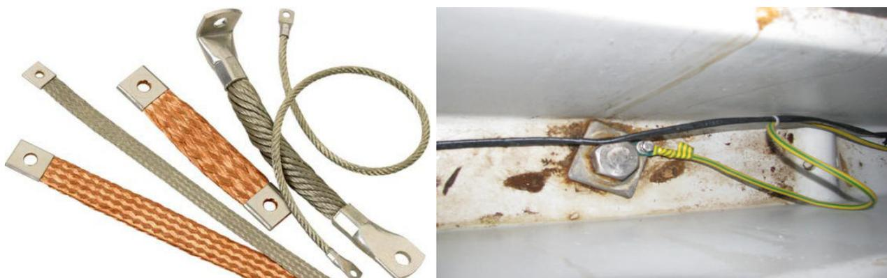
Su una barca di vetroresina non è possibile sfruttare la “carrozzeria” mettendo a massa il telaio stesso, risparmiando così un po di fili di rame e di complessità di schemi elettrici. Ogni utenza, nella maggioranza dei casi, ha un filo nero negativo e uno rosso positivo che la collegano alle batterie.
