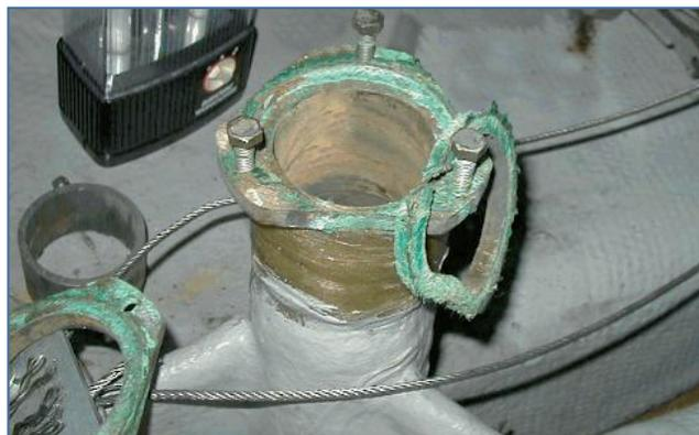
**Fig. 5** - Per ottenere una tenuta adeguata col premistoppa è necessario esercitare molta pressione sulla treccia, creando di riflesso attrito sull'asse.
