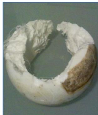
**Fig. 2** - La boccola è un fermo che serve a trattenere l'asse all'interno della losca. In materiale termoplastico è soggetta a usura. È bene monitorarla e sostituirla regolarmente. Un eccessivo gioco del timone potrebbe avere riflessi anche sulla losca.
