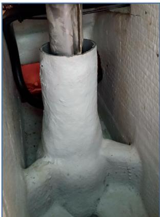
**Fig. 3** - Un leggero urto potrebbe causare crepe e aprire vie d'acqua nelle resinature che fanno da punto di innesto tra lo scafo e astuccio della losca.
