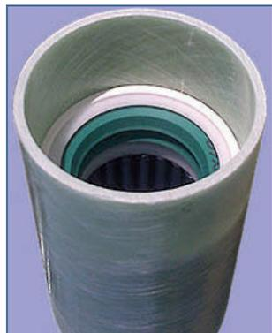
Fig. 4 - Le guarnizioni a labbro sono uno dei sistemi utilizzati per evitare il trafilaggio di acqua di mare dalla losca.
