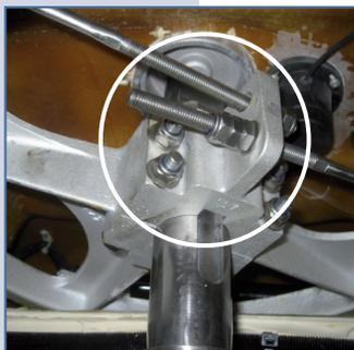
quando non è possibile l'impiego di una losca di lunghezza adeguata (per esempio quando il settore timoneria si trova appena sopra il cuscinetto inferiore).
