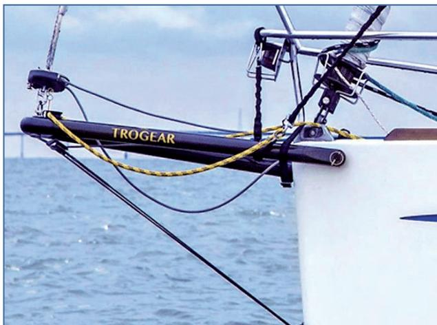
Secondo la norma Iso 8666 la lunghezza della barca include tutte le parti strutturali e integrali dell'unità escluse le appendici rimovibili senza azione distruttiva.
