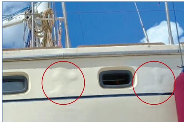
**Fig. 4** - Rigonfiamenti sulla murata che proiettano controluce le sagome dei ferri annegati sono un campanello d'allarme sullo stato di corrosione delle lande.
