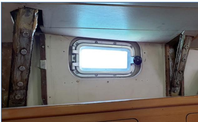
Fig. 2 - Attacchi delle lande facilmente ispezionabili a bordo di un Alpa 42.
