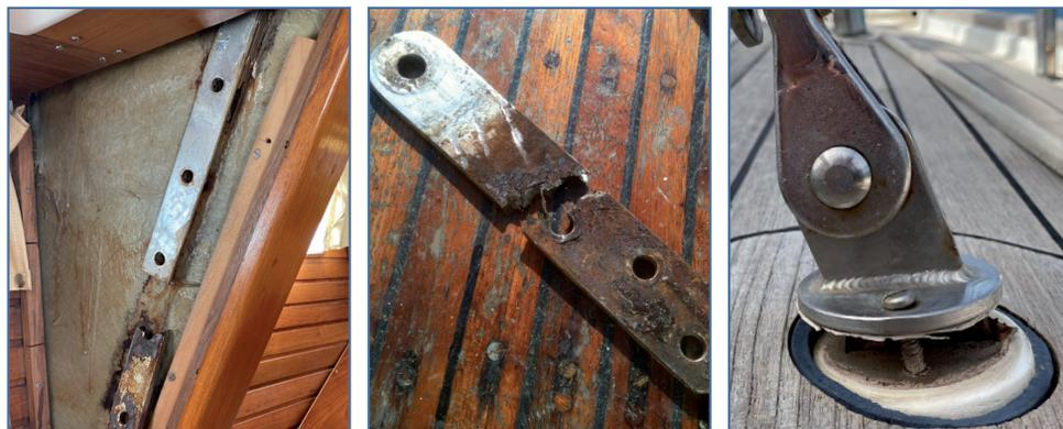
**Fig. 3** - Le sartie in inox possono sviluppare corrosioni, fessurazioni e cedimenti a causa d'infiltrazioni d'acqua e salino.
