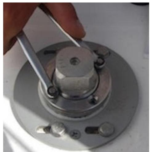
Attenzione alle ossidazioni e alla vite di fermo che sia in sede, integra e bloccata eventualmente anche con bloccante tipo *loctite*.
