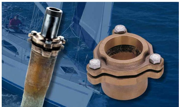
Il sistema “ **tubo + ghetta** ” viene utilizzato nel caso l'astuccio losca si interrompe poco sopra la linea di galleggiamento consentendo una discreta tenuta, all'albero di ruotare ed eventualmente “piegarsi” liberamente. Il sistema è costituito da un soffietto in neoprene collegato alle estremità, tramite fascette in inox, all'astuccio losca fisso e all'asse in rotazione consentendo fino a 90° di corsa del timone ( $\pm 45^\circ$ ), senza causare un'estensione anelastica della stessa.
