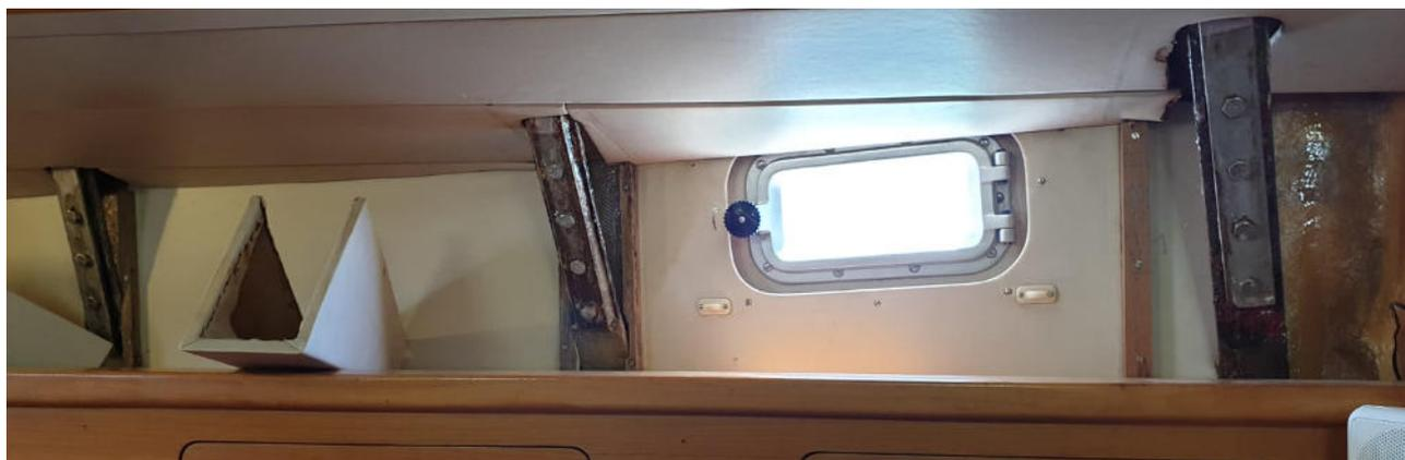
Sono generalmente realizzate in acciaio ( non sempre inox ), talvolta in alluminio per scafi in lega ed oggi sempre più spesso in composito. Oltre ai difetti di progettazione e materiali, ci sono tre fattori principali nell'aspettativa di vita di qualsiasi landa metallica: **corrosione, fatica ed età**.
