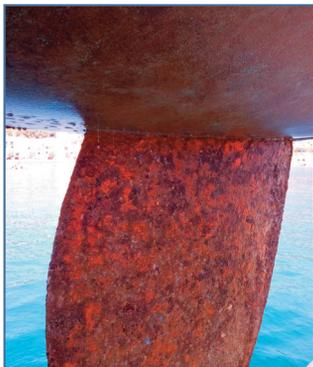
La corrente galvanica si verifica tra metalli di diverso potenziale immersi in ambiente salino. Il più debole cede elettroni e si ossida a una velocità crescente.
