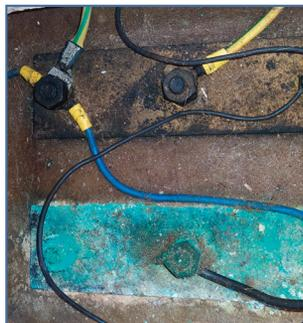
Le piastre di massa servono a collegare diverse parti di un sistema fino a un terminale collegato con il mare.
