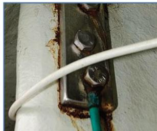
Col bonding di crea un collegamento tra i componenti metallici interni dello scafo. Nella foto quello a una landa.
