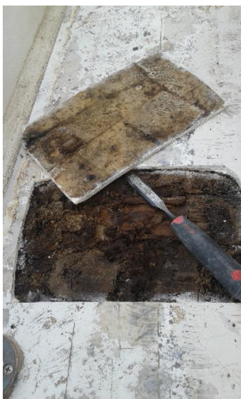
Rimozione vecchia anima in balsa coperta sandwich delaminata ( Taipei Formosa 42 )
