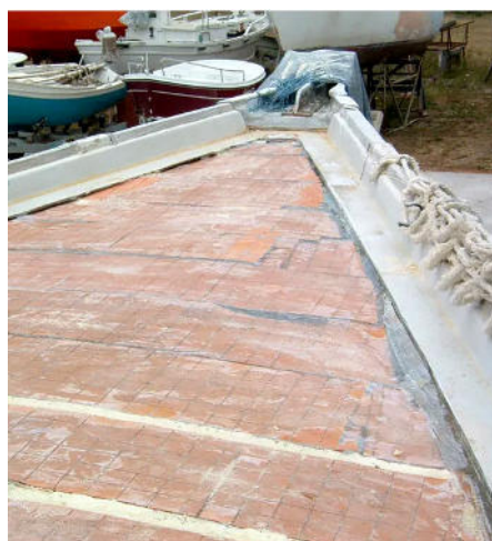
Rifacimento sandwich coperta alpa 11.50 con Termanto media densità
