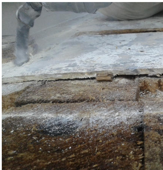
Rimozione vecchia anima in balsa coperta sandwich delaminata ( Taipei Formosa 42 )
