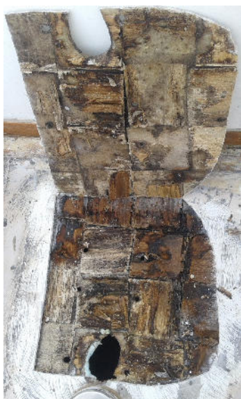
Rimozione vecchia anima in balsa coperta sandwich delaminata ( Taipei Formosa 42 )
