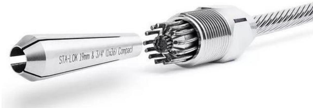
E' un metodo meccanico per terminali di funi metalliche (1×19, 7×7 , 7×19), possono essere montati in loco utilizzando strumenti manuali molto semplici, senza nessuna premisurazione. Molto utili averli a bordo come materiale di rispetto e di emergenza. Presentano un cono interno ( oliva ) inserito nel "nucleo" dei trefoli ed avvolto dai fili del giro esterno del cavo, si stringe e si blocca il tutto con il terminale scelto ad occhio, a forcella, a martelletto.
