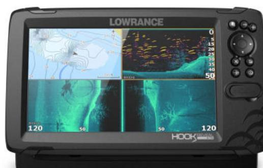
Molto utile averlo a bordo e in alcuni casi anche necessario. Trasmette grazie ad una sonda, il trasduttore sonar. Il **sagolino piombato** ( cima graduata con cono di piombo per zavorra ) ormai in pensione, è stato sostituito da anni con pratici display digitali e fishfinder dotati di sensori di temperatura, orografie del fondale e sagome di pesci presenti sott'acqua.
