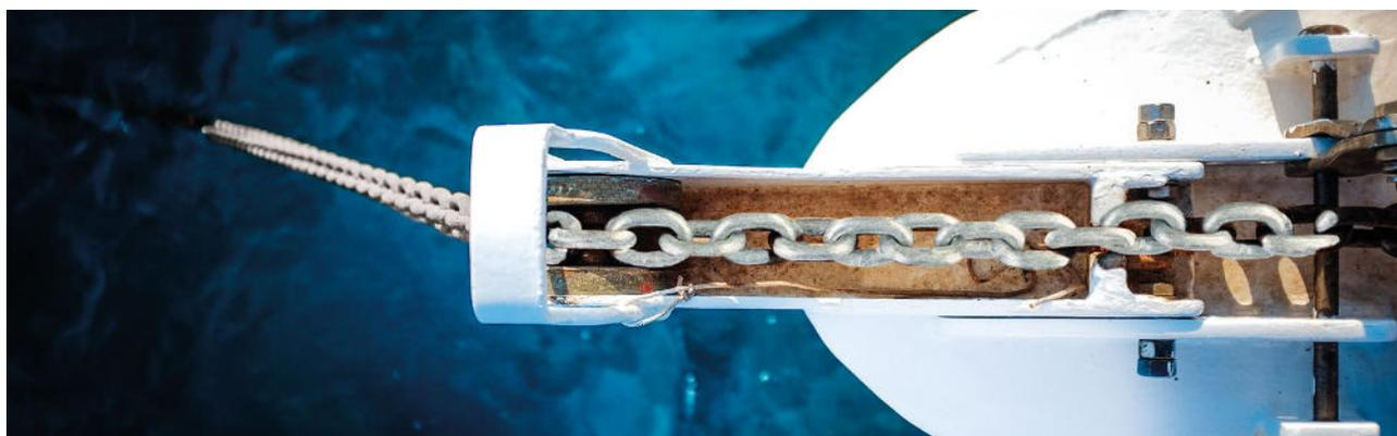
**LA CATENA** è uno dei componenti più importanti a bordo. Il materiale, il diametro, il passo, la lunghezza, la tipologia, il grado e il peso possono fare la differenza al momento dell’utilizzo. Nessuna catena metallica normale ( tipo grezza o “genovese” a passo lungo o non calibrata ) è stata pensata per andare a lavorare sotto il mare e sul nostro salpancora, resistendo alla tensione, alla corrosione e alla salinità dell’acqua.
