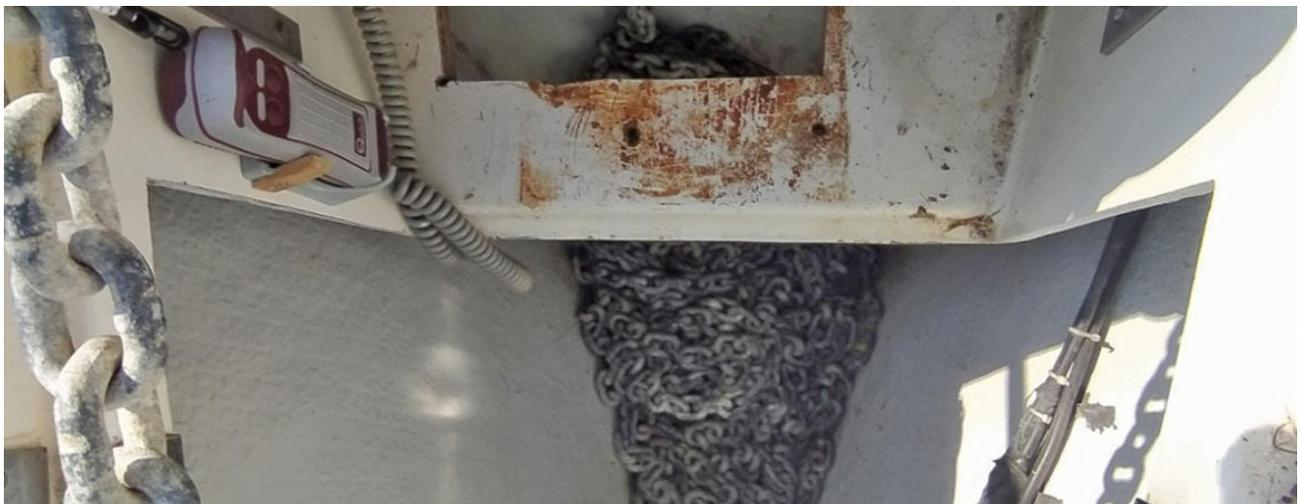
**POZZO CATENA.** A seconda dello spazio nel gavone dell'ancora si opta per quello verticale o ad asse orizzontale. Nel tipo verticale la catena fa un giro di 180° intorno al barbotin lavorando in orizzontale con un maggior numero di maglie a contatto, mentre in quello orizzontale il barbotin lavora in verticale con un angolo di soli 90°.
