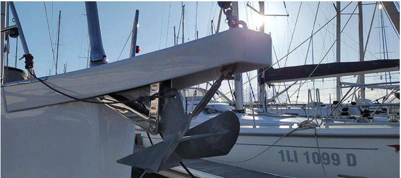
Indispensabile se la barca dispone del verricello salpa ancora grazie alla sua capacità di guidare correttamente la catena verso il barbotin o il cavo alla campana di tonneggio. In molti casi il musone è già integrato nel pulpito di prua o in una delfiniere multiuso, accessorio sempre più in voga. In tutti i casi deve garantire una compatibilità universale con diverse tipologie di ancore.
