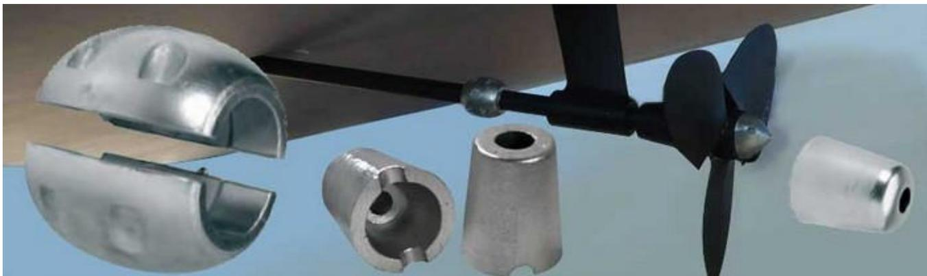
La scelta del materiale dell’anodo è questione di “nobiltà” e va fatta in base al materiale da proteggere e alla natura dell’acqua in cui l’imbarcazione è immersa. Non sempre sono di zinco. L’acqua salata è un elettrolita favoloso per innescare i processi di corrosione. Qui vengono utilizzati gli anodi di zinco o anche di alluminio mentre in quelle dolci, che è sicuramente meno conduttiva si utilizzano anodi in magnesio.
