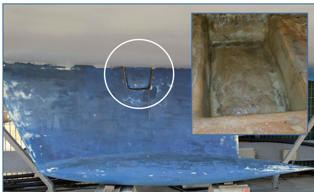
Fig. 4 - Alcune chiglie vengono sagomate e integrate al recesso della ghiotta della sentina. Un punto nevralgico in caso di urti, all'origine di possibili infiltrazioni.
