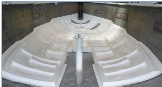
Fig. 1 - I controstampi sono prefabbricati e incollati con resine. Sono detti integrali e semintegrali a seconda che lascino o meno accesso ai prigionieri della deriva.
