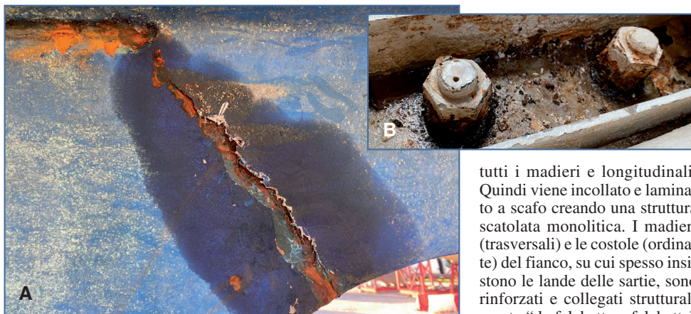
Fig. 2 - Una cricca nel punto di giunzione tra chiglia e deriva in ghisa ha generato una vistosa crepa (A). In alto, una piastra dei prigionieri con dadi ossidati (B).
