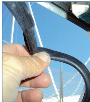
Fig. 1 - A bordo è imprescindibile un controllo alle guarnizioni di oblò e osteriggi.
