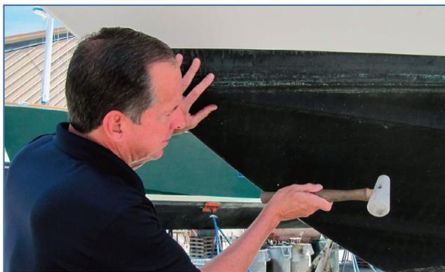
**Fig. 4** - L'esame del fasciame della barca viene effettuato a percussione, utilizzando l'apposito maglietto (in figura) o i più sofisticati martelli digitali.
