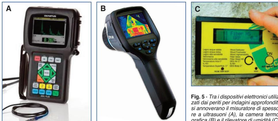
**Fig. 5** - Tra i dispositivi elettronici utilizzati dai periti per indagini approfondite si annoverano il misuratore di spessore a ultrasuoni (A), la camera termografica (B) e il rivelatore di umidità (C).
