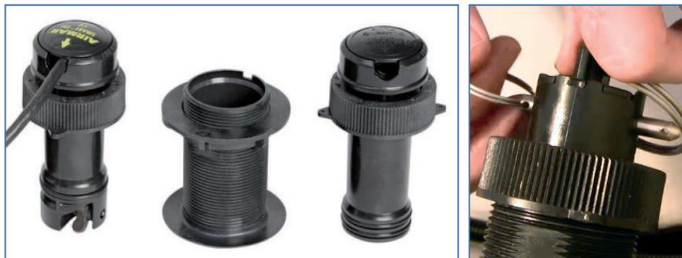
**Fig. 3** - Durante il controllo di sensori e trasduttori è bene accertarsi che a bordo siano presenti e sempre a portata di mano i relativi tappi. L'ideale sarebbe tenerli legati con un cordino in prossimità del passascafo.
