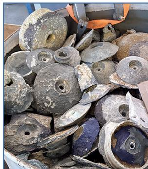
**Fig. 1** - Gli anodi vanno sostituiti quando consumati al 60 per cento.
