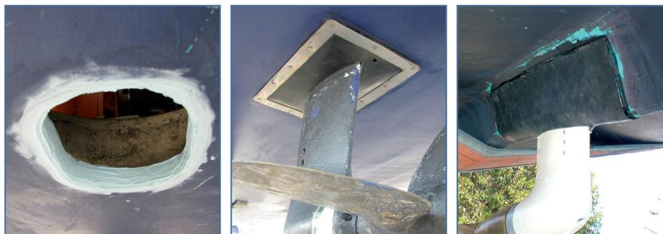
**Fig. 6** - La guarnizione rettangolare esterna al sail drive è incollata allo scafo e spesso flangiata con un profilo perimetrale.
