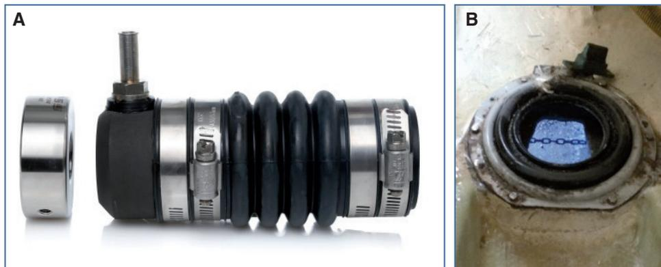
**Fig. 5** - Costose ma efficaci: la boccola PSS shaft seal per linea d'asse non richiedono manutenzione e garantiscono la tenuta all'acqua per 40.000 ore di lavoro. A destra la membrana del sail drive che va sostituita dopo 6 o 7 anni.
