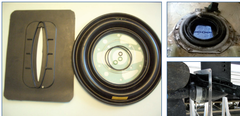
Fig. 4 - Le membrane e la flangia di tenuta della motorizzazione S-drive vanno verificate periodicamente e sostituite almeno ogni 5-7 anni. La prima non deve presentare spaccature o segni di usura, la seconda deve avere i bulloni integri.
