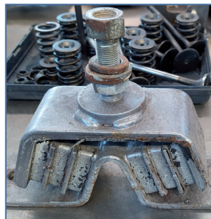
Fig. 5 - Il logorio dei silent block può portare a vibrazioni e al disallineamento fra motore e asse dell'elica.
