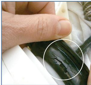
*L'unica possibilità di perdita di una pompa a pedale è la rottura della membrana, facilmente sostituibile.*
