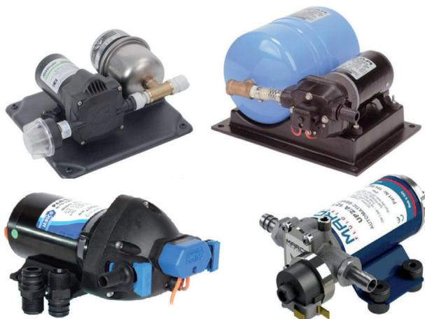
*Le autoclave (pompa più pressatato) più usate sono di due tipi: a girante (in alto a sinistra) o a membrana (in alto a destra). In media producono entrambe da 8-10 fino a 15-17 Lt/minuto. In basso il dettaglio delle sole pompe elettriche.*
