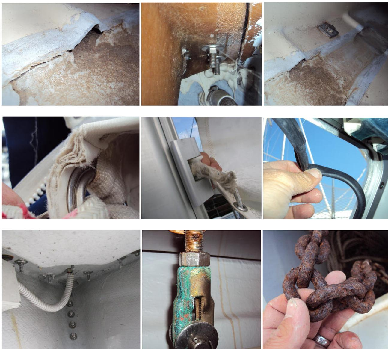
Controllo integrità e scadenza **tubo flessibile in gomma gas gpl** e **serraggio fascette** ( di norma meglio due per lato ) e posizione stagna **bombola gas** ( ancoraggio e ventilazione ), regolatore di pressione, rubinetto di chiusura e linea rigida in rame ( raccordi ed eventuali strozzature )
