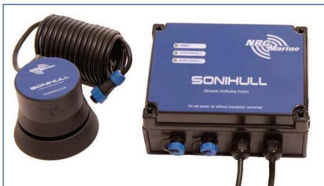
Fig. 4 - Gli antifouling a ultrasuoni diffondono onde sonore tramite trasduttori posti all'interno della barca. Sulla superficie della carena si genera così il fenomeno della cavitazione che crea un ambiente inospitale per i microrganismi.
