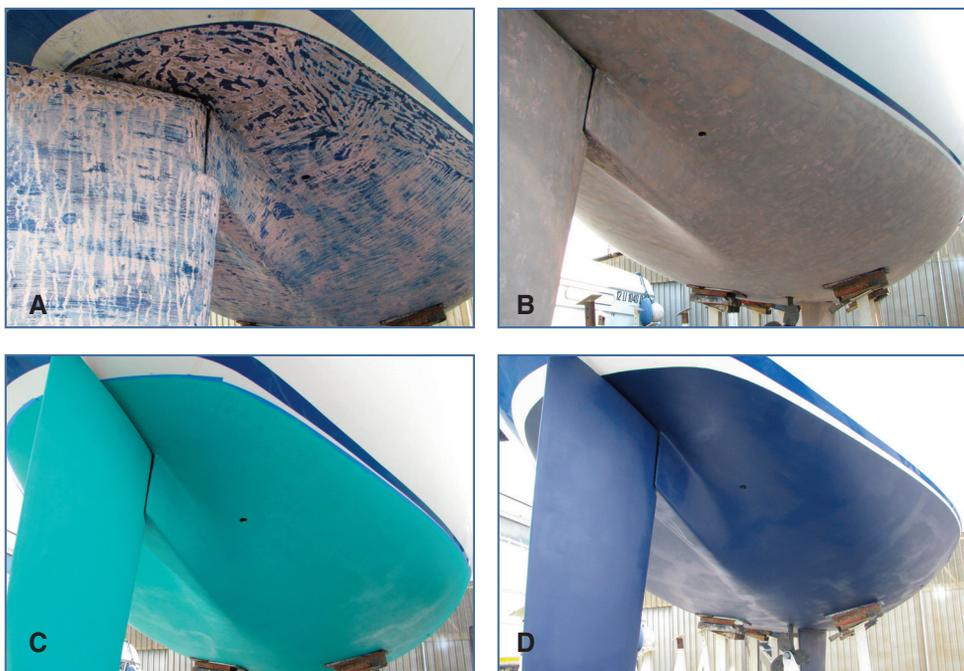
**Fig. 3** - Il processo di rimozione di vari strati di antivegetativa accumulati negli anni richiede un intervento importante che prevede raschiatura (A), carteggiatura orbitale (B), applicazione del gelcoat (C) e della nuova antivegetativa (D).
