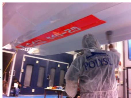
L'uso delle nano particelle nella antivegetative permette di eliminare i biocidi e quindi di risolvere problemi di inquinamento e rilascio di particelle nocive in mare. Nel diporto nautico nano trattamenti in opera viva trasformano le caratteristiche della superficie trattata , conferendo un film 100% ecocompatibile con effetto *pelle di delfino* che impedisce l'adesione permanente di alghe, denti di cane e di tutta la vegetazione marina.
