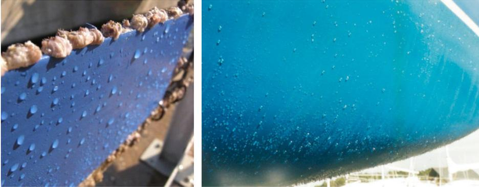
Sono prodotti senza biocidi ( *biocide free* ) realizzati con matrici **siliconiche o al teflon** ( effetto antiadesivo ), rivestimenti fluoropolimerici ( antiaderenti ) o a base di silossani ( idrorepellenti ), che basano tutta la loro efficacia essenzialmente sulla bassa energia superficiale. Queste pitture esercitano un'azione inibente verso gli organismi incrostanti, di tipo **fisico** e non **chimico** come le normali antivegetative tradizionali.
