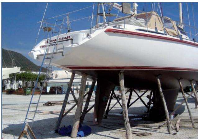
**Fig. 2** - I puntelli laterali devono sopportare la spinta utile a mantenere in equilibrio lo scafo, assorbendone un carico minimo. A destra uno spessore di legno.
