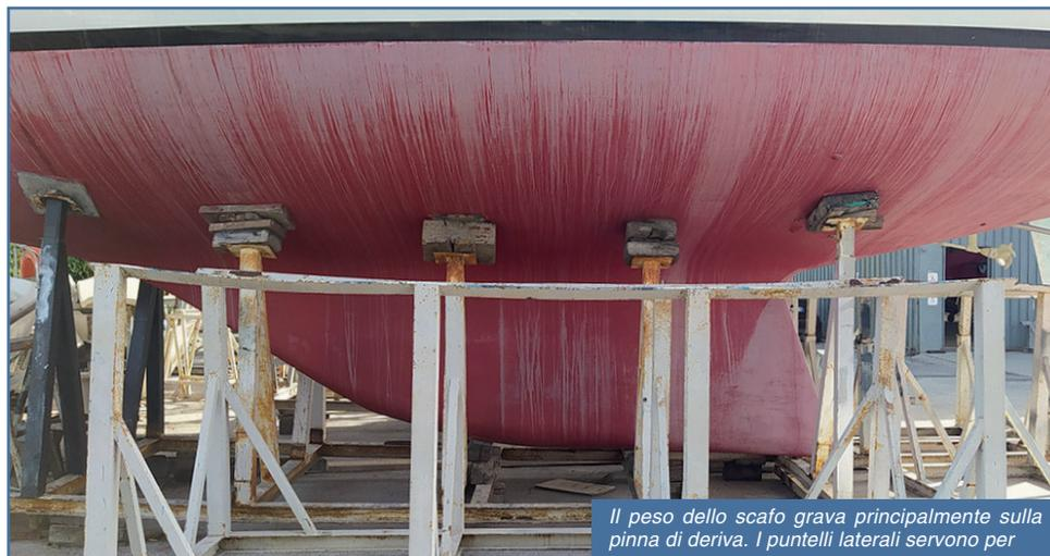
*Il peso dello scafo grava principalmente sulla pinna di deriva. I puntelli laterali servono per*
